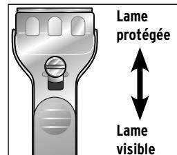
1. Repoussez la partie supérieure de façon à ce que la lame insérée soit visible.
