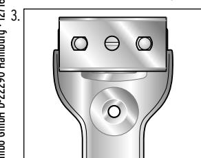
Setzen Sie das Gehäuseoberteil wieder auf und drehen Sie die Schraube hinein.
