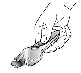
2. Entfernen Sie feste Verunreinigungen auf Glas-keramikoberflächen, indem Sie den Schaber flach über die Oberfläche führen.
