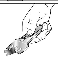
2. Pevně nečistoty na sklokeramických površích odstraňte plochým pohybováním škrabky po povrchu.
